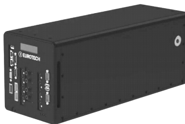
图 5 使用车载高性能计算平台加速 AI 算法的开发,如液体冷却装置 DYNACOR40-36(来源:Eurotech)
